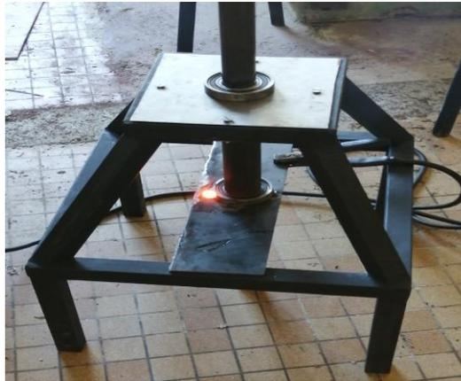
Figure IV.12 : Le support de rotor
