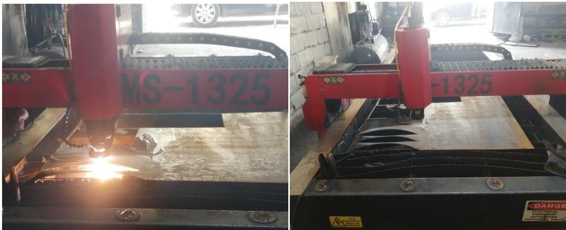
**Figure IV.10 :** machine de découpe par plasma.
