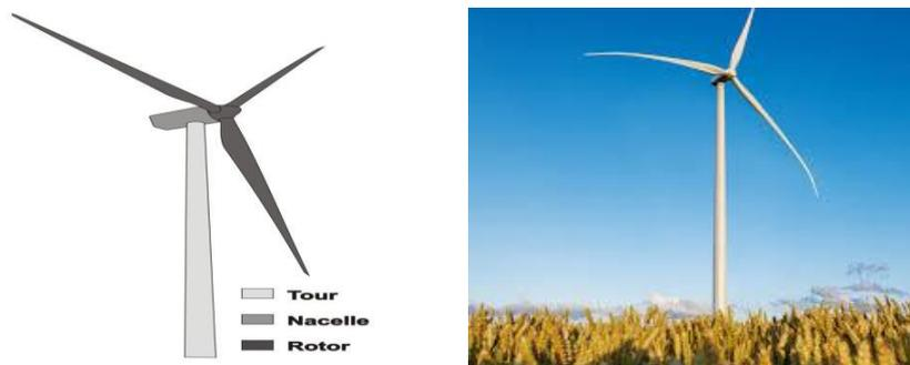
Figure I.9 : Schéma d'une éolienne à axe horizontal.
