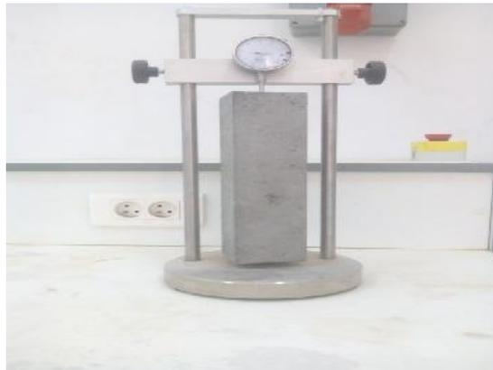
Fig.III.11:Appareil de retrait.
