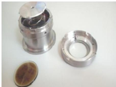
Fig.III.1. Pastille d'analyse chimique et son support.
