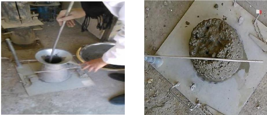
Fig.III.5: Essai du cône d'Abrams.
