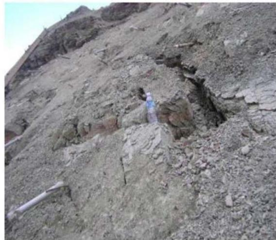
**Figure I- 4:** Glissements rotationnels
