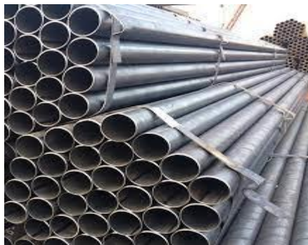
Fig. II .9 Tuyau en l'acier noir
