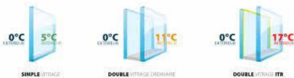
Fig. III.2. Température d'un vitrage.
