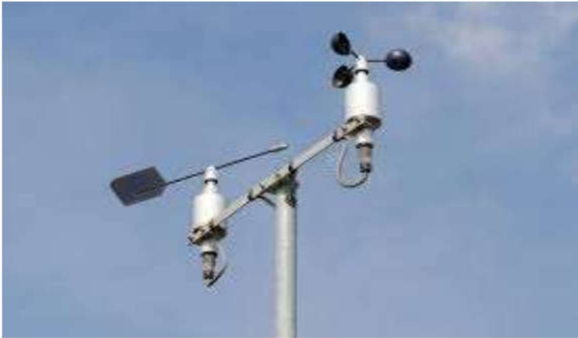
Figure I.6 : Anémomètre avec une girouette à gauche[6]
