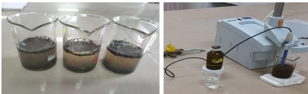
Figure 2 : Mesure du compost après mélange avec de l'eau distillé.
