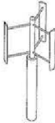
Figure II.7: Les pales des rotors Darrieus-H.
