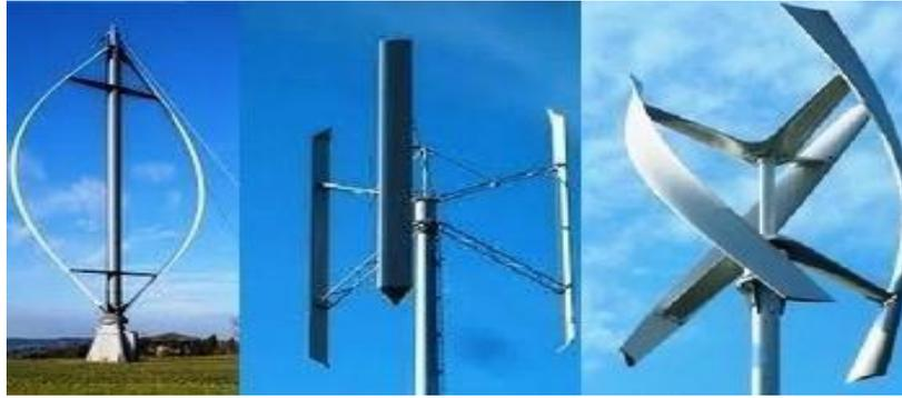
Figure I.8 .Les éoliennes de type Darrieus (RAPIN 2014).
