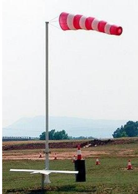
**Figure 2-11 Une manche à air permet d'évaluer approximativement la vitesse du vent, et sa direction**
