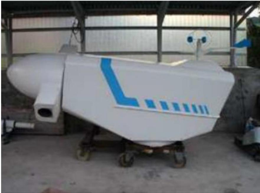
**Figure I.5: Nacelle d'une moyenne éolienne.**
