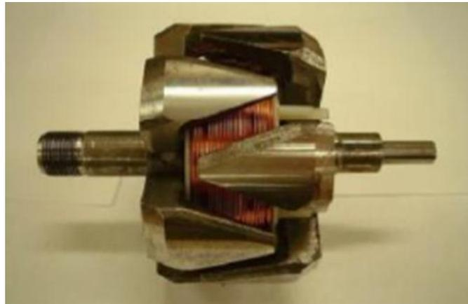
**Figure I.1 : Rotor d'un alternateur à griffes.**
