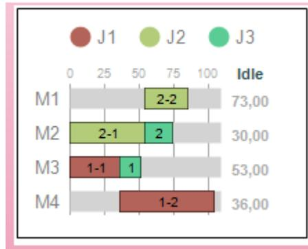
**Figure 4.24 :** Exemple de Diagramme de Gant obtenu par Algorithme Génétique de problème 3x4
