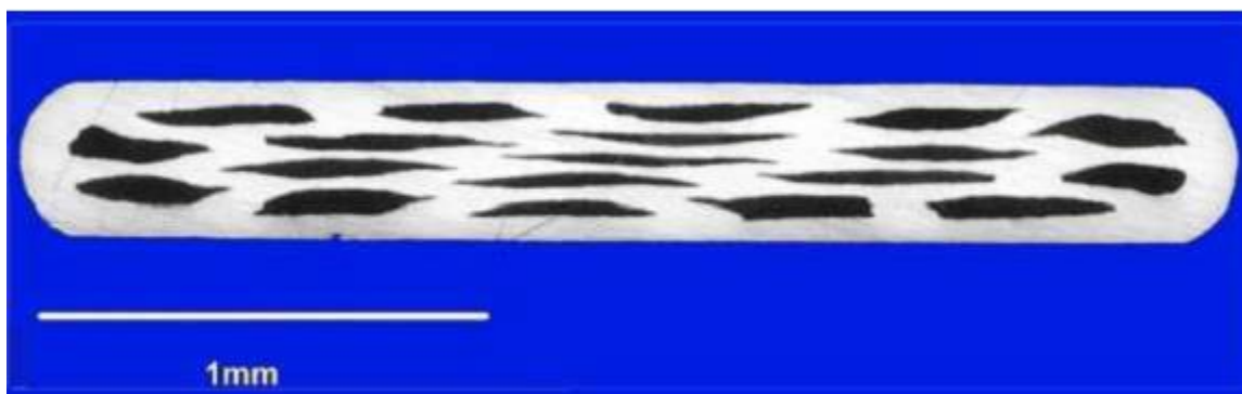
Fig. I. 5 : Ruban composé de 19 filaments supraconducteurs. [6]
