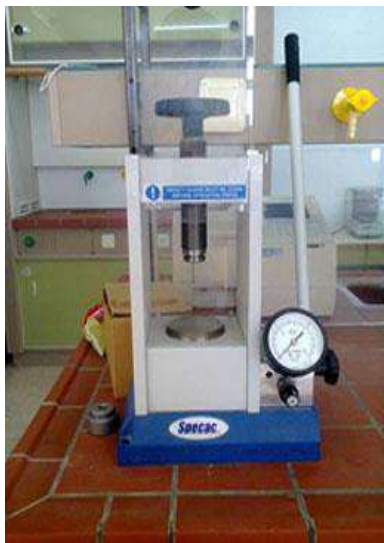
Figure II. 2: Schéma du dispositif de pressage axial.
