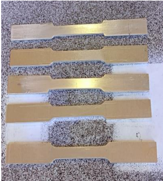
Figure II.6: Eprouvette de fatigue usinées et polies.
