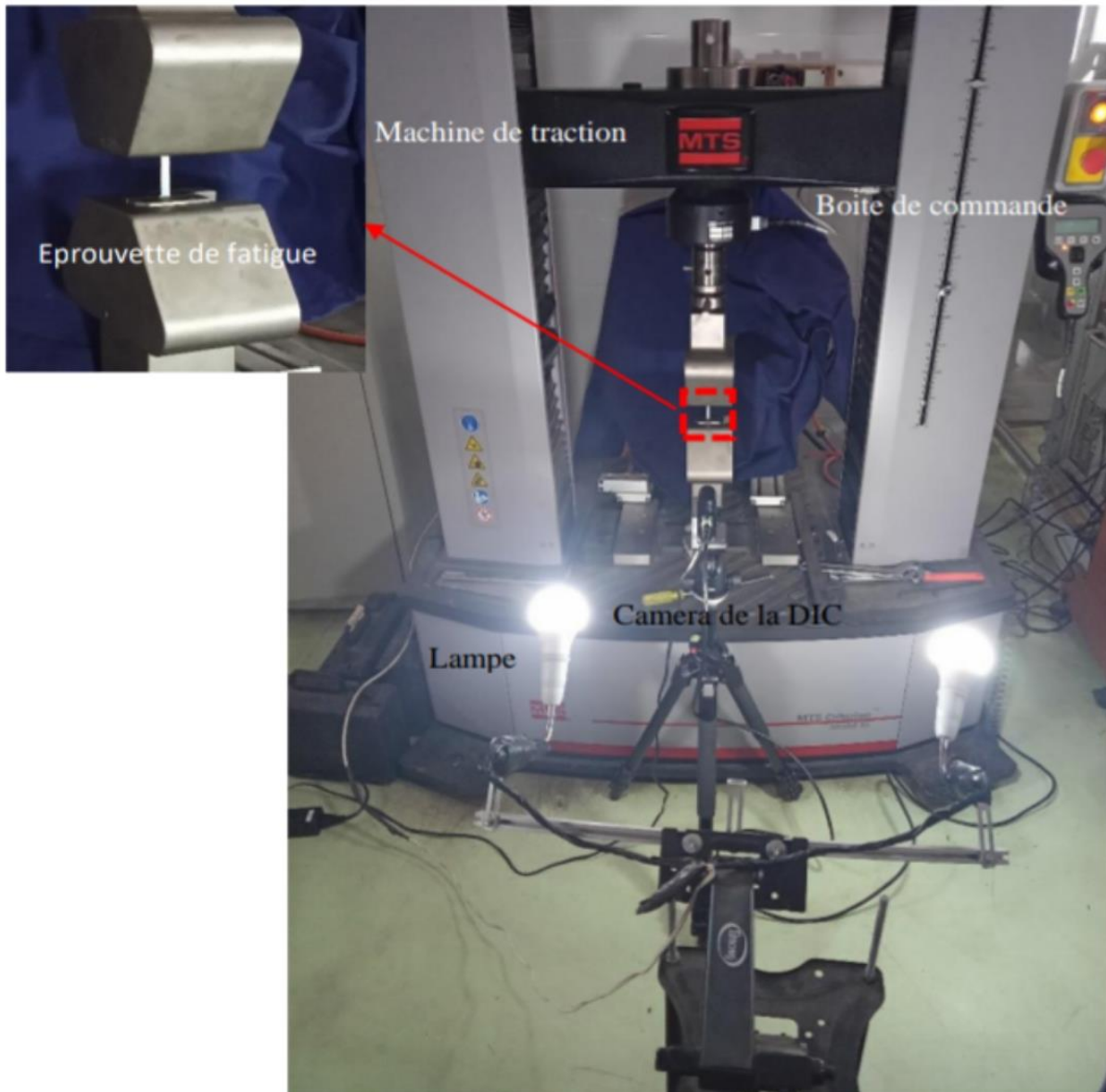
Figure II.2: Montage expérimental de corrélation d'images numériques bidimensionnel : Essai Traction-DIC.
