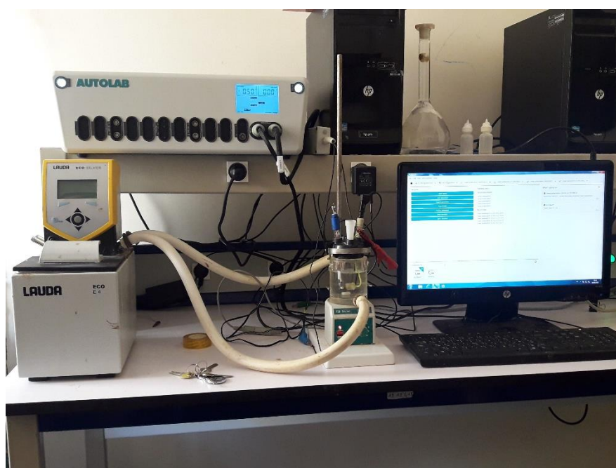
Figure III.8 : Dispositif expérimental des tests de polarisation
