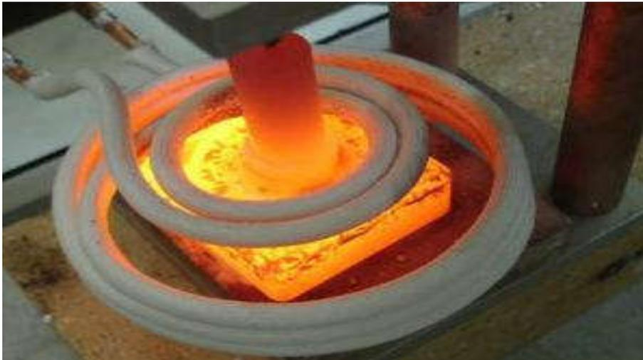
**Fig. I.8 : recuit acier et normalisation par induction**
