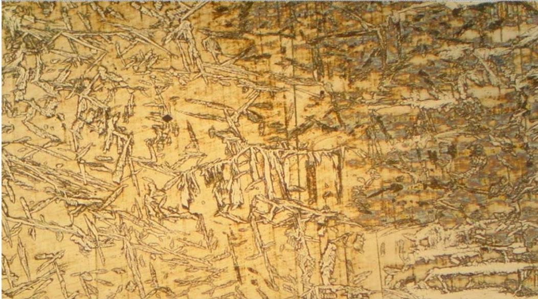
**Figure IV.6 : Microstructure la ZL d'acier (2205) GX200**
