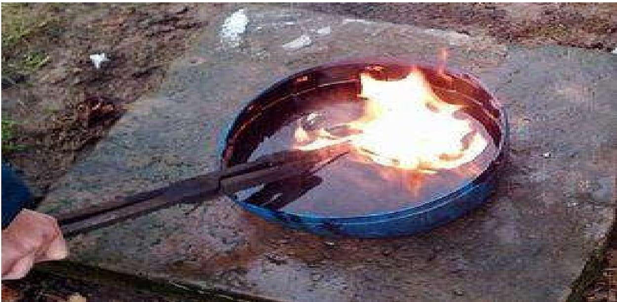
**Fig. I.6 : un image présente de traitement thermique (la trempe)**
