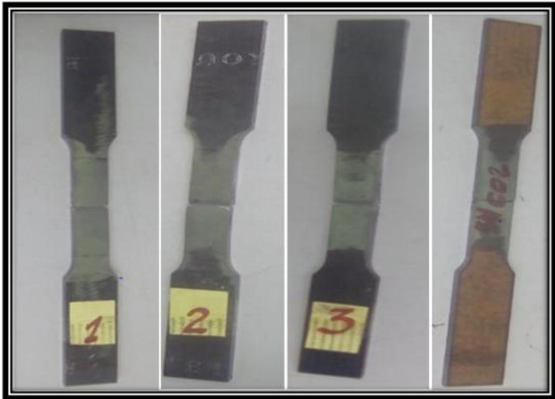
*Figure V.12: Rupture des éprouvette S1, S2, S3, S4 après l'essai de traction indiquées par 1, 2, 3, et sans CO2 respectivement*
