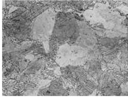
**Figure I.05 :** Structure perlitique Acier à 0,8 % C - 0,21 % Mn - 0,22 % Si Traitement : 800 °C (30 min) – four Attaque Natal (3 %) Grossissement : 900. [11]
