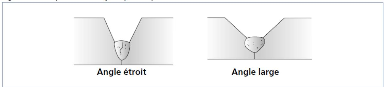
**Figure 3.3. Préparation d'un joint pour la prévention de la fissuration à chaud**
