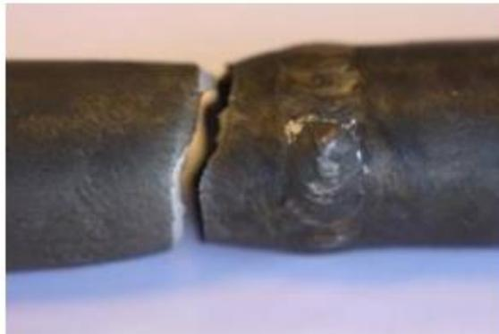
**Figure4.2. Localisation rupture après essai de traction sur un tube en soudure bout à bout**
