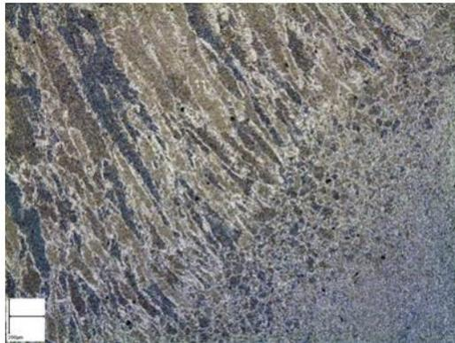
**Figure 4.7. Visualisation macrographique d'un cordon de soudure**
