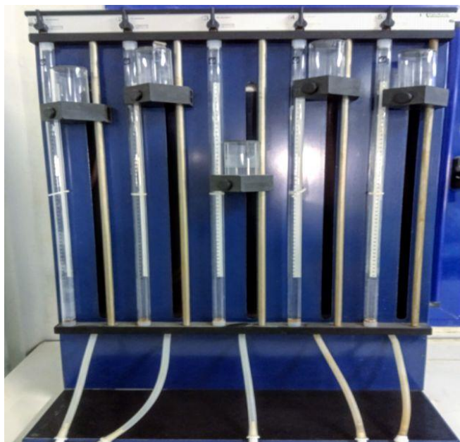
Figure III-9 : Calcimètre de Bernard (utilisé pour analyse du calcaire total) ( photo original ).
