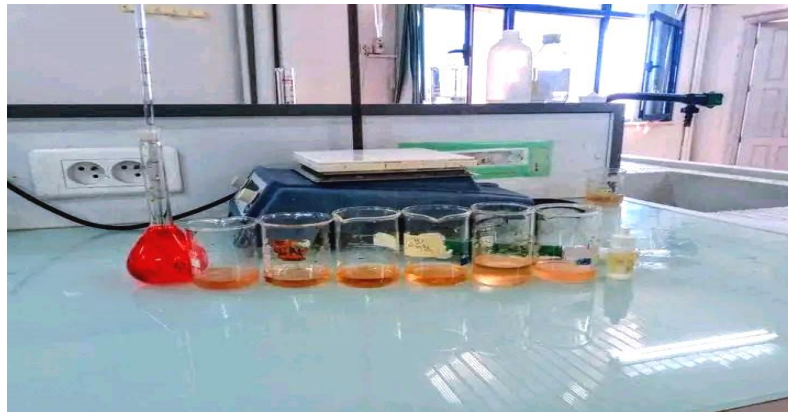
Figure III-12 : Titration de Carbonate et bicarbonate (photo original)
