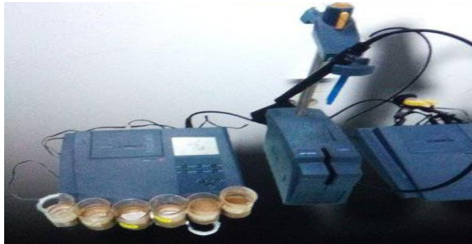
Figure III-8 : Conductivité-mètre utilisé pour la détermination du la CE de nos échantillons (photo originale)
