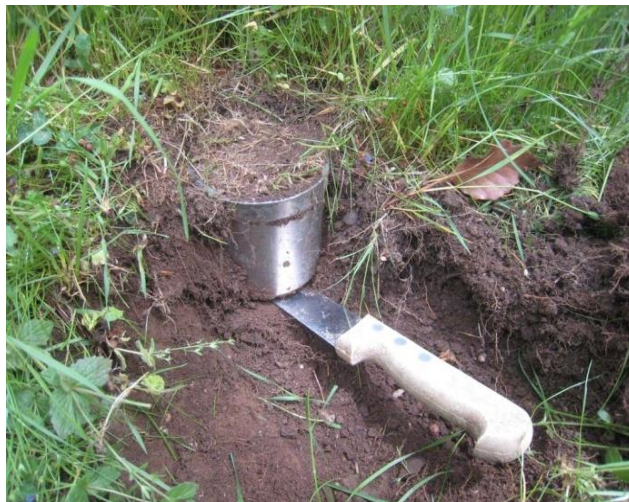
Figure III-6 : Cylindre enforcé dans le sol ( https://agripsol-prjet-agroforestrie .net )
