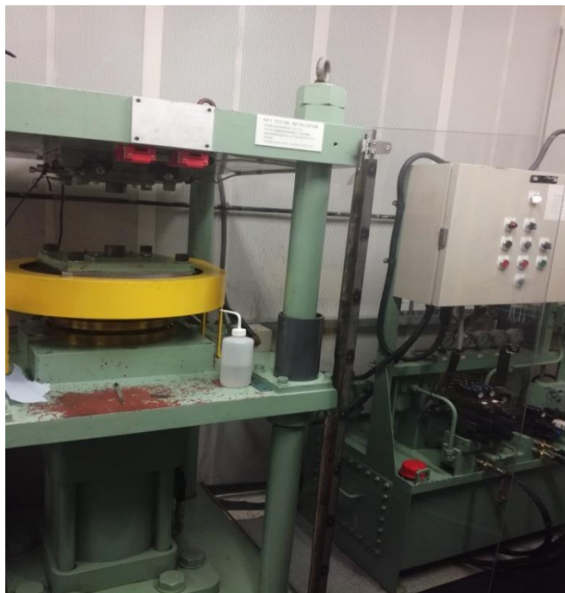
Figure II.2 : Photographie de la machine HPT utilisée dans la présente investigation (Faculté d'Ingénieur et de l'Environnement, Université de Southampton, Angleterre).
