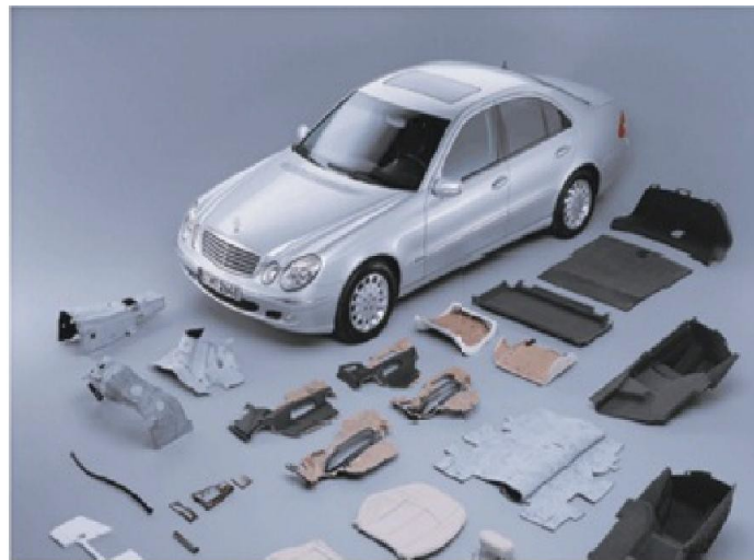
Figure 20 : Composants d'automobile en composites de fibres végétales [24].
