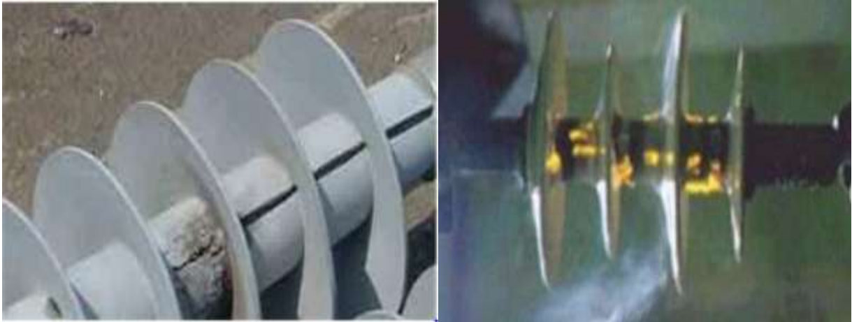
Figure II. 8. Arcs partiels établis le long de bandes sèches (a) qui peut résulter en une importante fissuration de l'enveloppe (b) [29].
