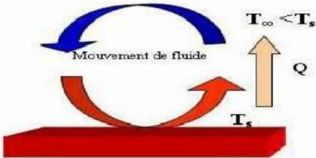
Figure I. 3: Schéma de transfert de chaleur par convection.
