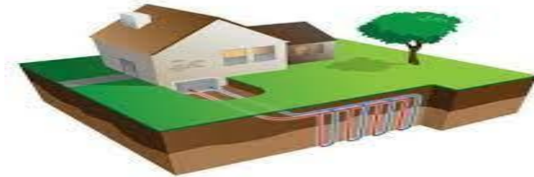
Figure 2.5: échangeur de chaleur air/sol Serpentins. [5]
