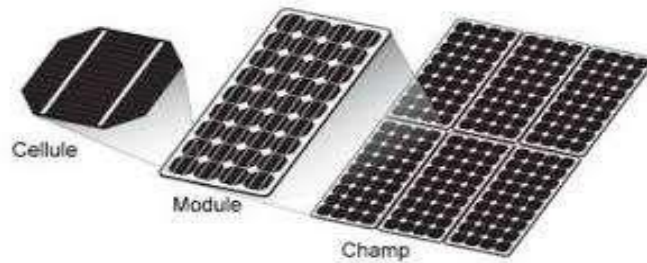
Figure I—6 : Cellule, module et panneau photovoltaïque
