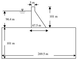
Fig. 1. Dam-foundation rock system. Système barrage-fondation rocheuse.
