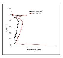
Fig. 11. Distribution of shear stresses along dam height for model without SSI and model with SSI. Distribution des contraintes de cisaillement le long de la hauteur du barrage pour le modèle sans ISS et modèle avec ISS.
