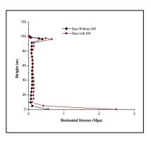
Fig. 9. Distribution of horizontal stresses along dam height for model without SSI and model with SSI. Distribution des contraintes horizontales le long de la hauteur du barrage pour le modèle sans ISS et modèle avec ISS.
