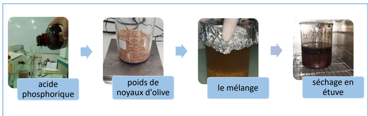
Figure II.2 : préparation de charbon actif
