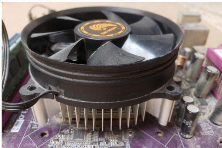
**Figure I.1 :** Un dissipateur de chaleur refroidi par ventilateur sur le processeur d'un ordinateur Personnel. À droite, un dissipateur de chaleur plus petit refroidit un autre circuit intégré de la Carte mère
