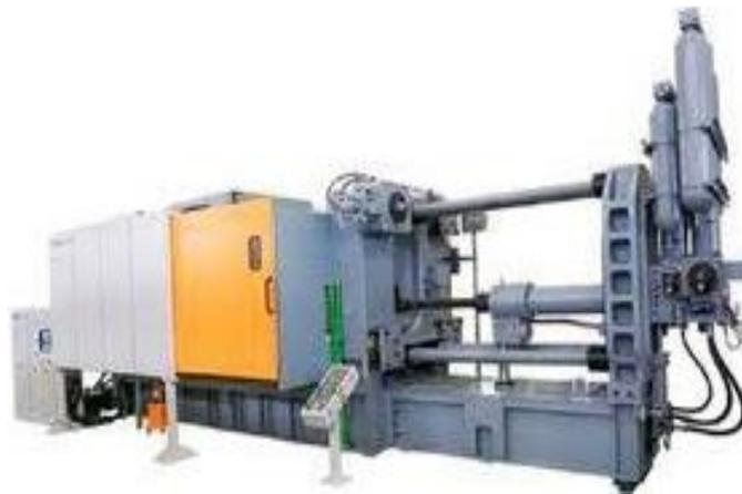
**Figure I.19 :** Machine de moulage sous pression
