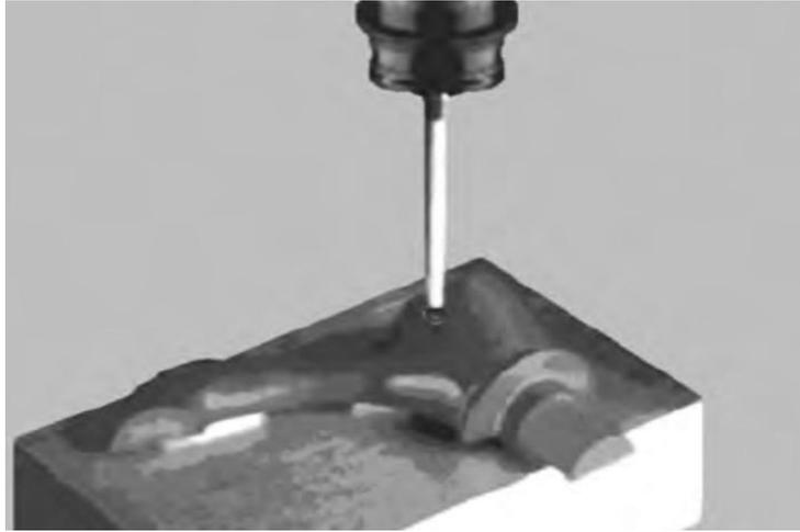
**Figure II.2 :** palpeur tactile à balayage de contact.
