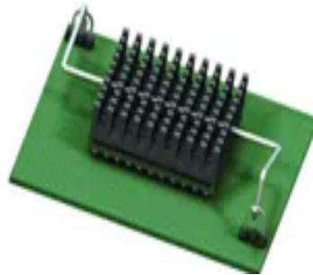
**Figure I.13** : forme de fil 'Clips en Z'
