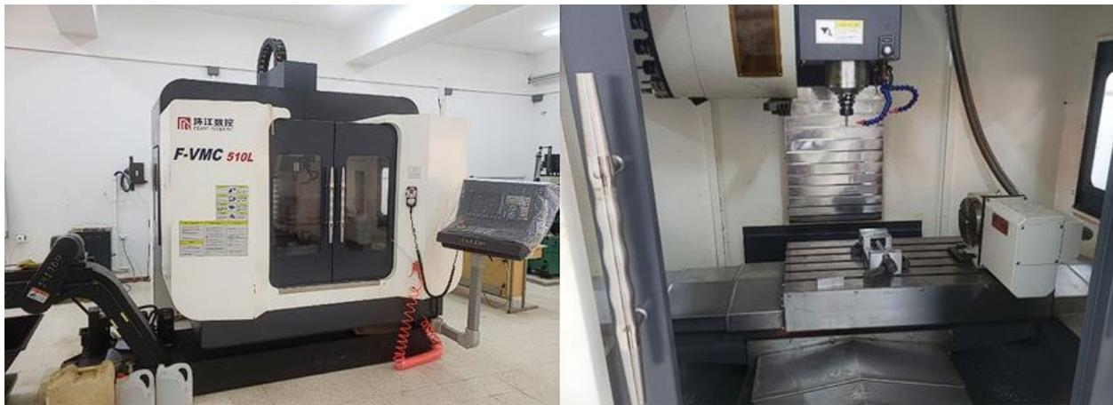
**Figure IV.2 :** Centre d'usinage multitâches (5 axes)
