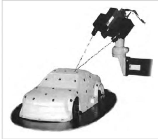
Figure II.3 : Appareil scan optique
