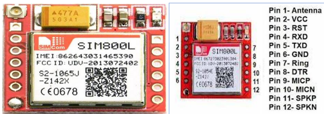
Figure 39 : Module GSM (SIM 800L)
