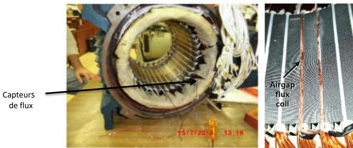
Figure17 exemples de capteur de flux d'entrefer utilise pour le diagnostic des machines asynchrone [49][50].
