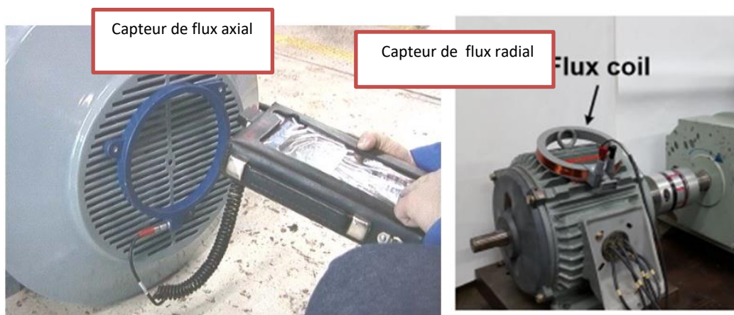
Figure16 exemples de capteur de flux d fuite utilise pour le diagnostic des machines asynchrone.[68,57]
