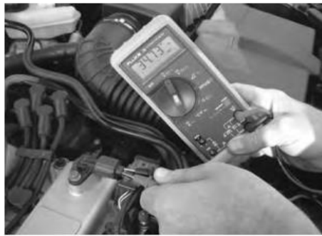
Figure IV. 1 : Test du capteur de vilebrequin/arbre à cames
