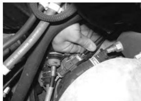
Figure IV. 2: Test de la sonde lambda
