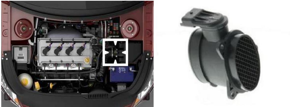
Figure III. 9: capteur débitmètre d'air massique
