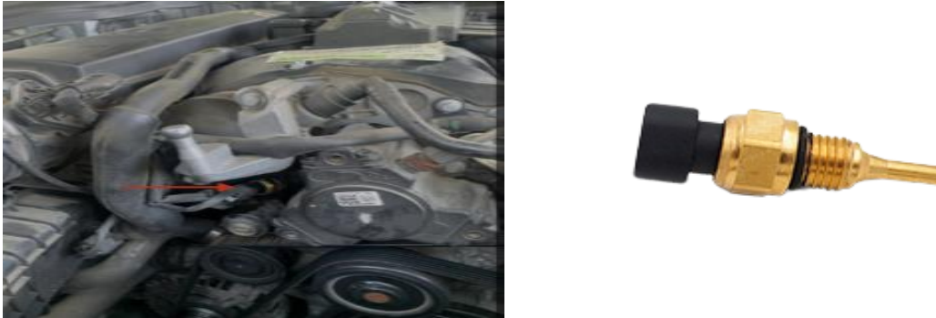
Figure III. 8: Capteur de température carburant
