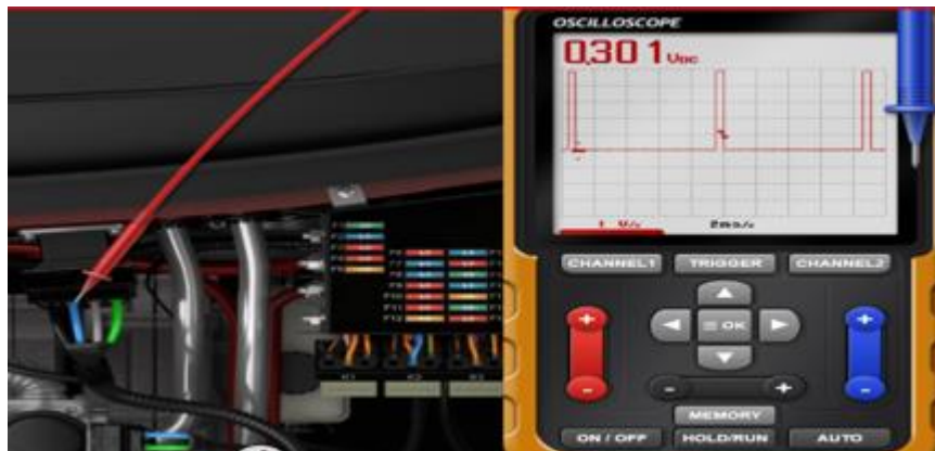
Figure III. 6 : teste de capteur pédale d'accélération
