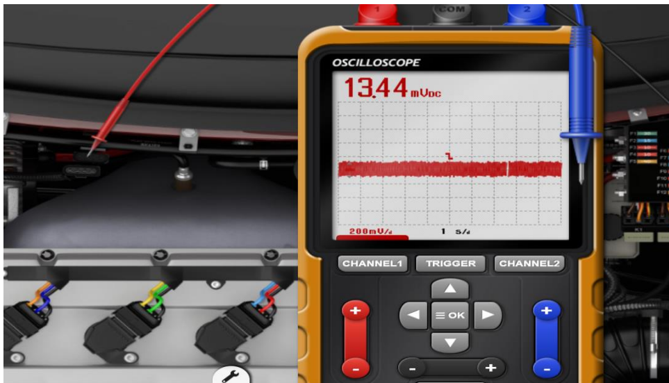
Figure III. 16: test de capteur d'oxygène
