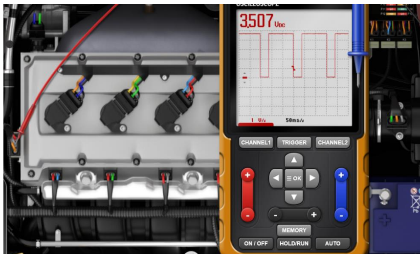
Figure III. 24: teste de capteur d'arbre came.
