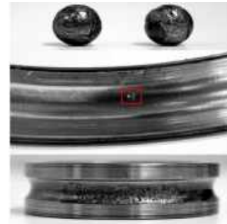
Fig. 2. Défaut des roulements à la fin de l'essai [2]
