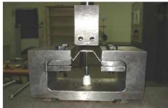
Fig 1. Dispositif d'étirage-pliage en V adapté sur la machine de traction
