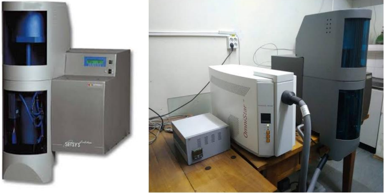
Figure III.10 Analyse thermogravimétrique SETSYS Evolution ATG-ADT.
