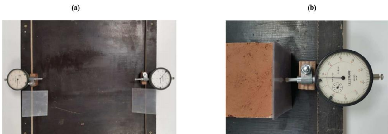
Figure III.13 (a) Dispositif d'expérimentation pour évaluer le retrait. (b) Mesure du retrait d'un échantillon.
