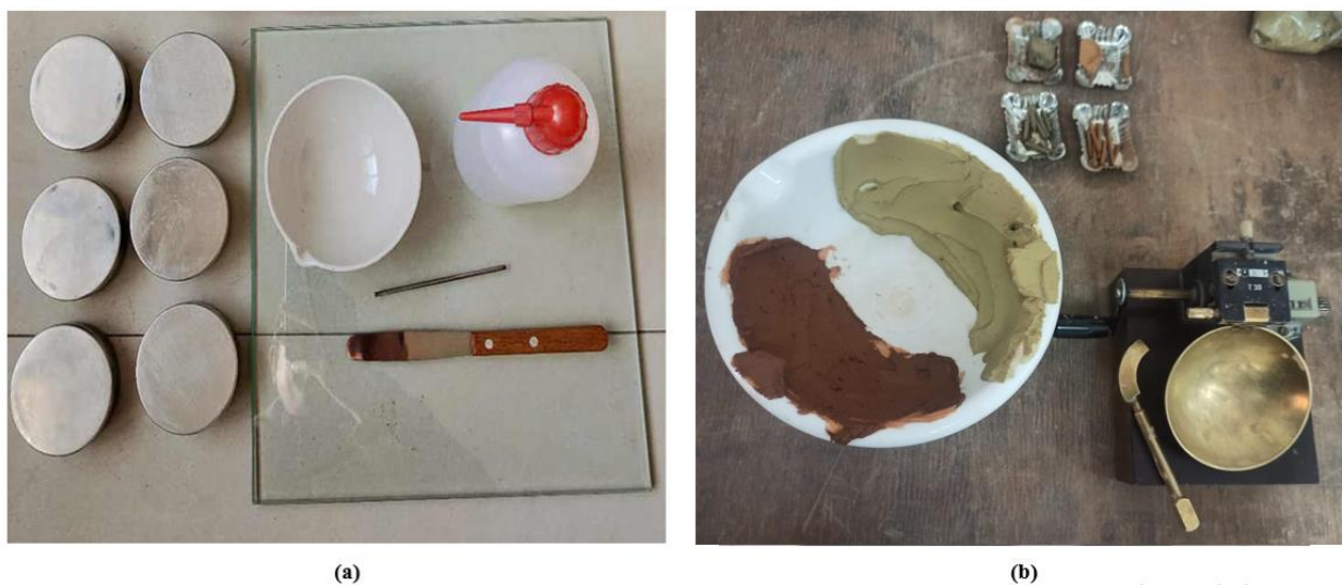
Figure III.7 Limites d'Atterberg : (a) Limite de plasticité au rouleau, (b) Limite de liquidité à la coupelle de Casagrande.
