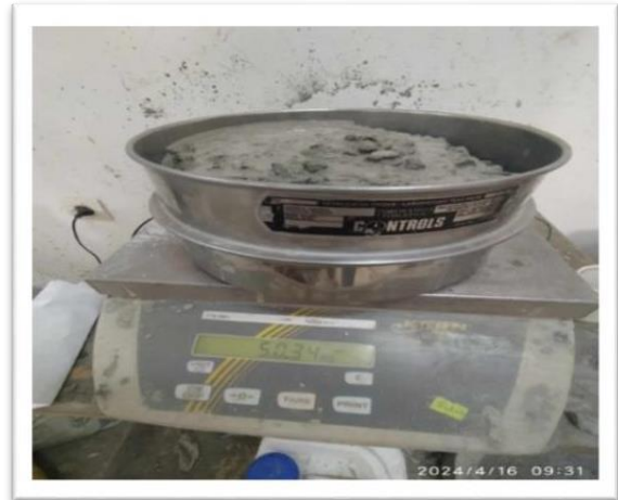
Figure 06 : Représentation de l'essai de stabilité au tamis [20]
