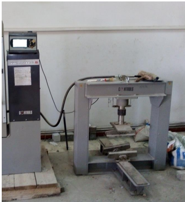
Figure 43: essai de traction et flexion et éprouvette
