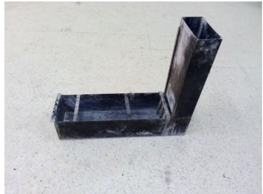
Figure 05 : - Représentation schématique de l'essai à la boîte en L [20]
