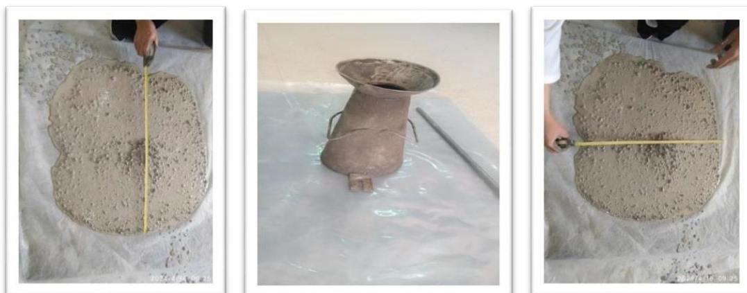
Figure 39: Essai d'étalement au cône d'Abram's
