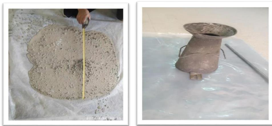
Figure 04 : Essai d'étalement au cône d'Abram's selon la norme NF EN 12350-8. [20]
