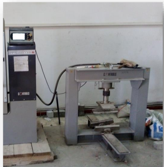
Figure 08: Mesure de la résistance à la flexion des (7*7*28) cm
