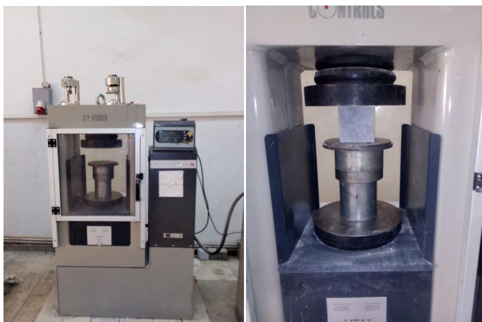
Figure 42: Essai compression : a) machine et éprouvette, b) éprouvette destructeur
