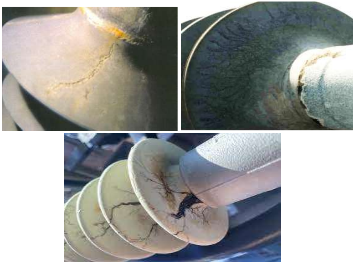
Figure II. 8. Dégradation de l'isolateur composite
