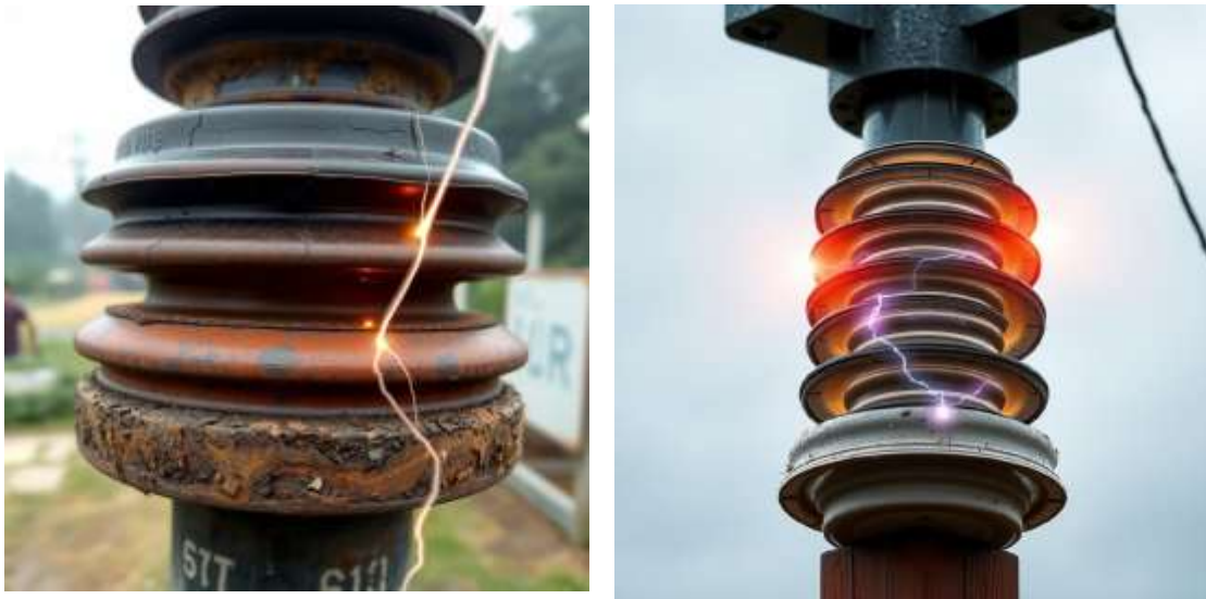
Figure II. 4. Illustration des courants de fuite sur un isolateur composite soumis à la pollution
