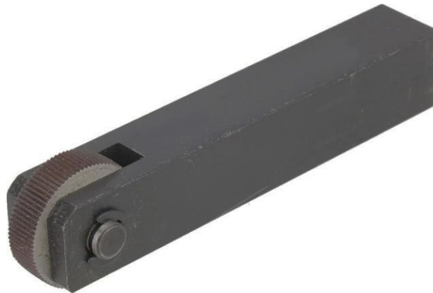
Figure II.2 : Outils de moletage à une seule roue
