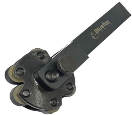
Figure II.4 : outils de moletage à roue unique avec molettes
