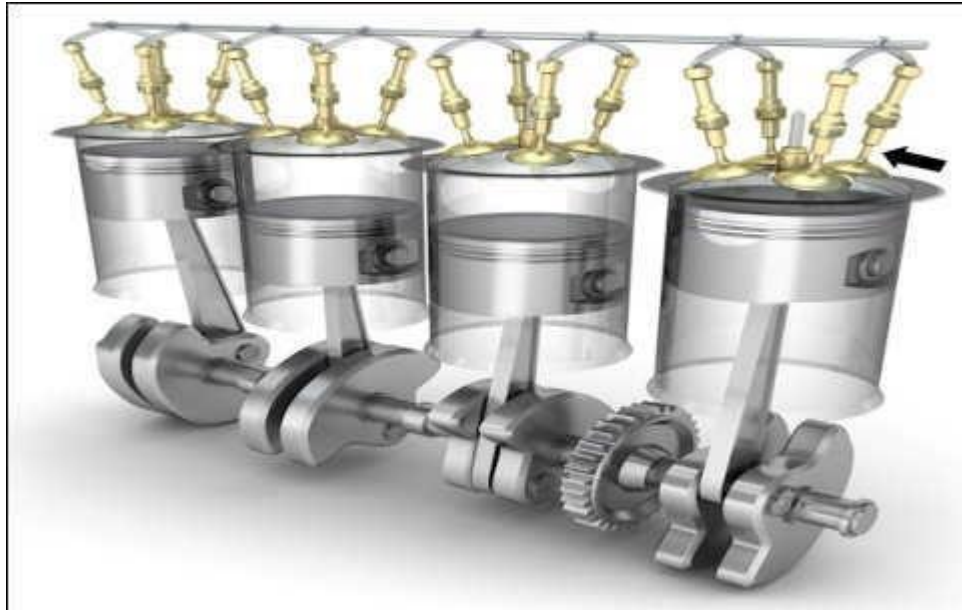
Figure I. 5 Moteur type en ligne [6]
