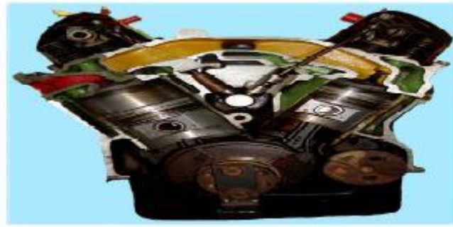
Figure I. 7 Coupe transversale d'un moteur avec cylindres en V [6]
