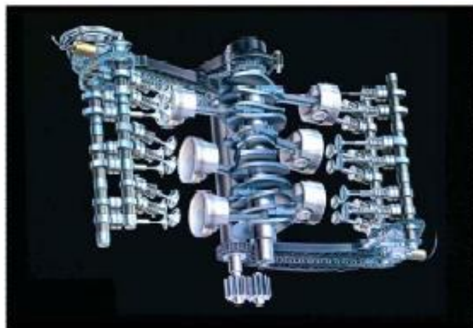
Figure I. 9 Moteur a cylindres opposées(en H) [6]
