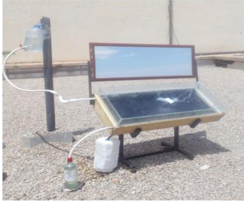
الشكل 16-III: التركيب التجريبي "لمقطر شمسي مع مرآة عاكسة". [45]
