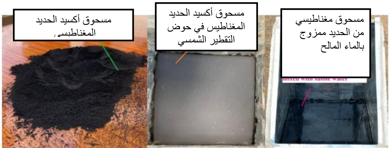
الشكل 4- II : رسومات تجريبية لجهاز التقطير الشمسي المعدل (يستخدم مسحوقا مغناطيسيا)
