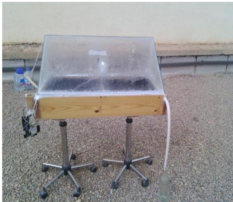
الشكل 1-III: جهاز تقطير "شمسي بأربعة زجاجات" [41]
