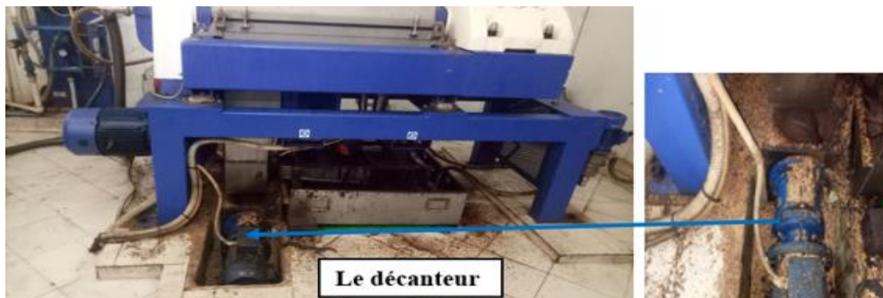
Figure I.5: Séparation des phases solides (grignons)-liquides (mélange d'eau et d'huile)
