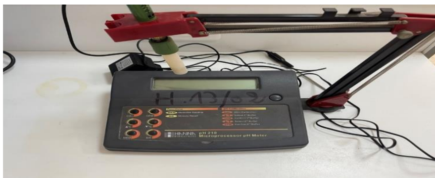
Figure I.13: Microprocesseur pH Mètre "Hanna pH 210"
