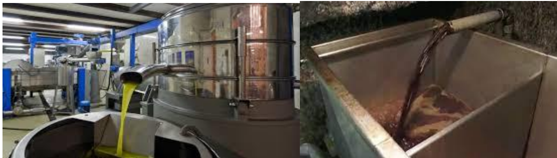
Figure I.8 : L'extraction finale de l'huile d'olive - margine
