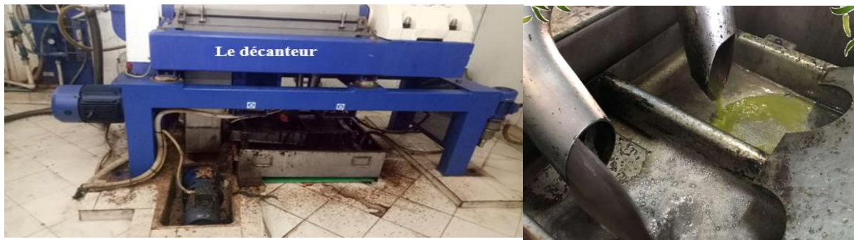
Figure I.7: Séparation des phases liquides (Huile)-liquides (margine) [1]
