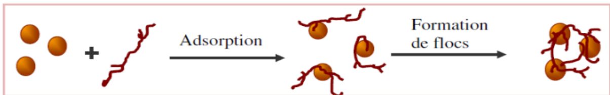
Figure II.9: Adsorption et pontage à l'aide de polymères
