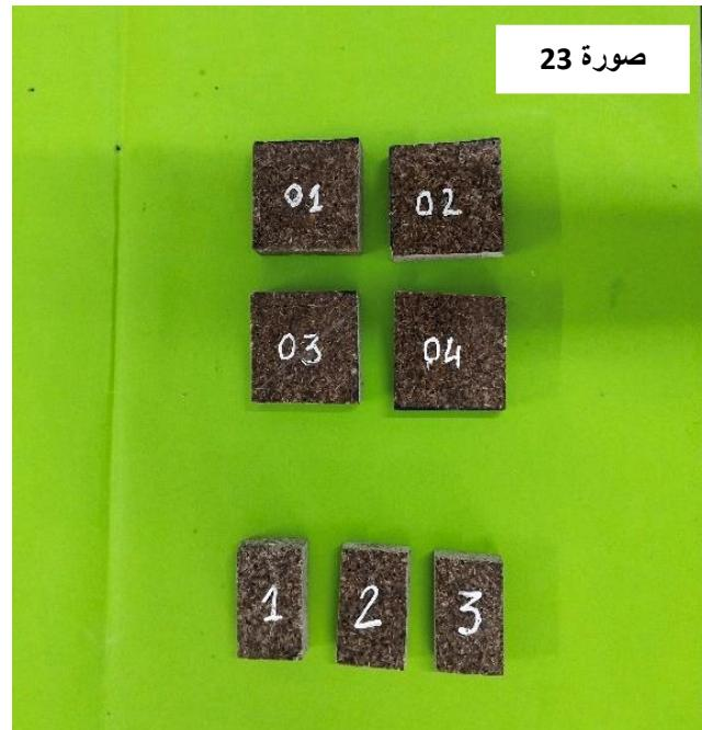
الصورة 23 توضح العينات المعدة من اجل اختبار test d'humidite et resistance d'eau
