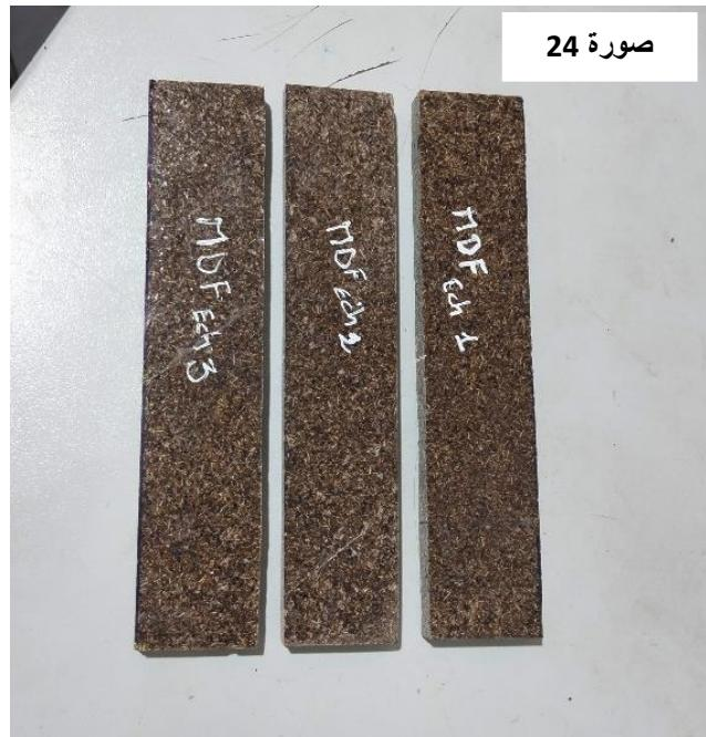
الصورة رقم 24: توضح العينات المعدة من اجل اختبار Test de flexion
