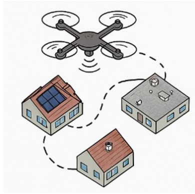
Şekil 1. Drone ile çatı görüntülerinin toplanma süreci ve uçuş rotası
