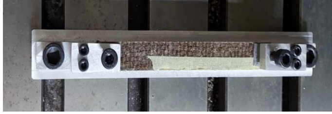
Fig. 8. Raw specimen on the actual machining setup
