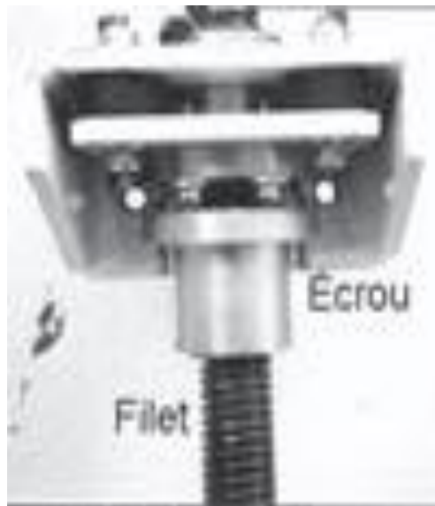
Figure III.10– Système vis-écrou d'une plate-forme élévatrice.
