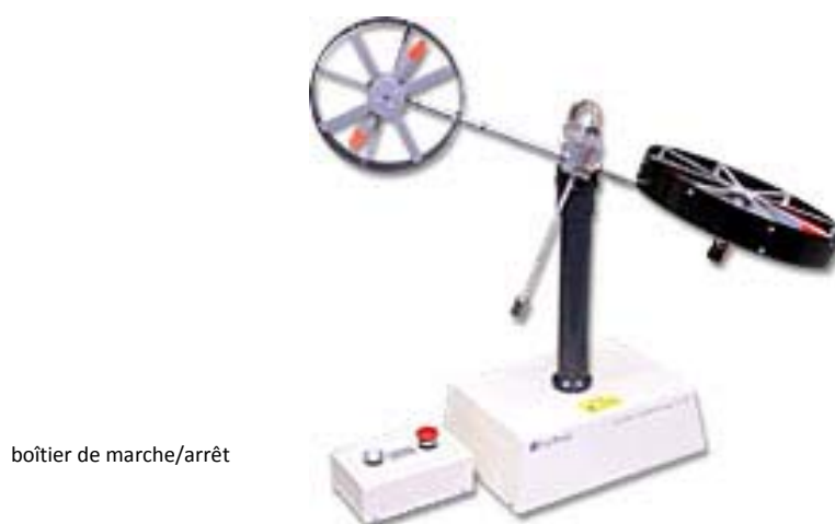
Figure II.1 Simulateur d'hélicoptère à deux degrés de liberté
