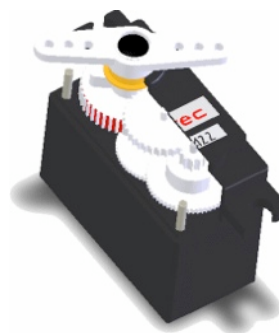
Les servomoteurs intègrent souvent des réducteurs de sortie pour augmenter le couple
